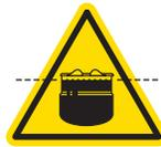
Do not fill kettle above recommended level marked on outside of kettle. / Ne remplissez pas la chaudière en excès du niveau recommandé marqué sur la chaudière. / No llene la marmita arriba del nivel recomendado marcado fuera de la marmita.
